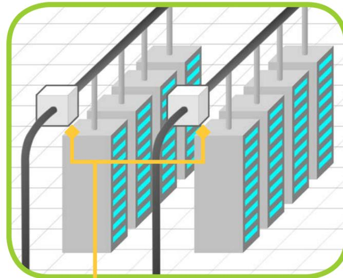
Messmodul für Busschienen am Abzweig der Busschienenhauptleitung installieren, um die Rack-Stromversorgung zu überwachen
